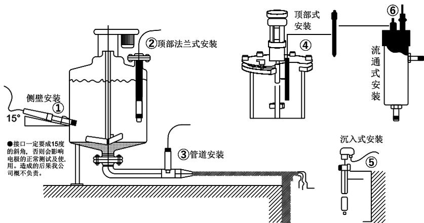
图 4 常见安装方式示意图
