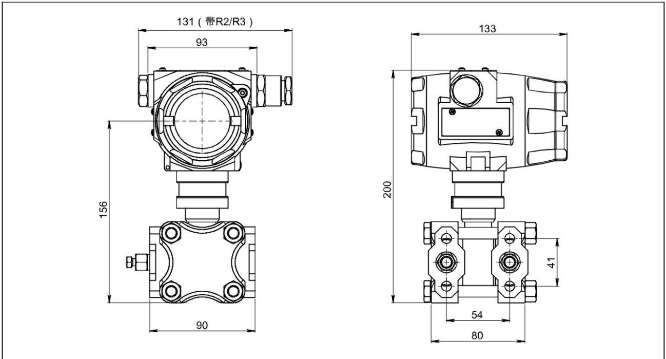
不带显示 (A) 整机尺寸图 (单位: mm)
