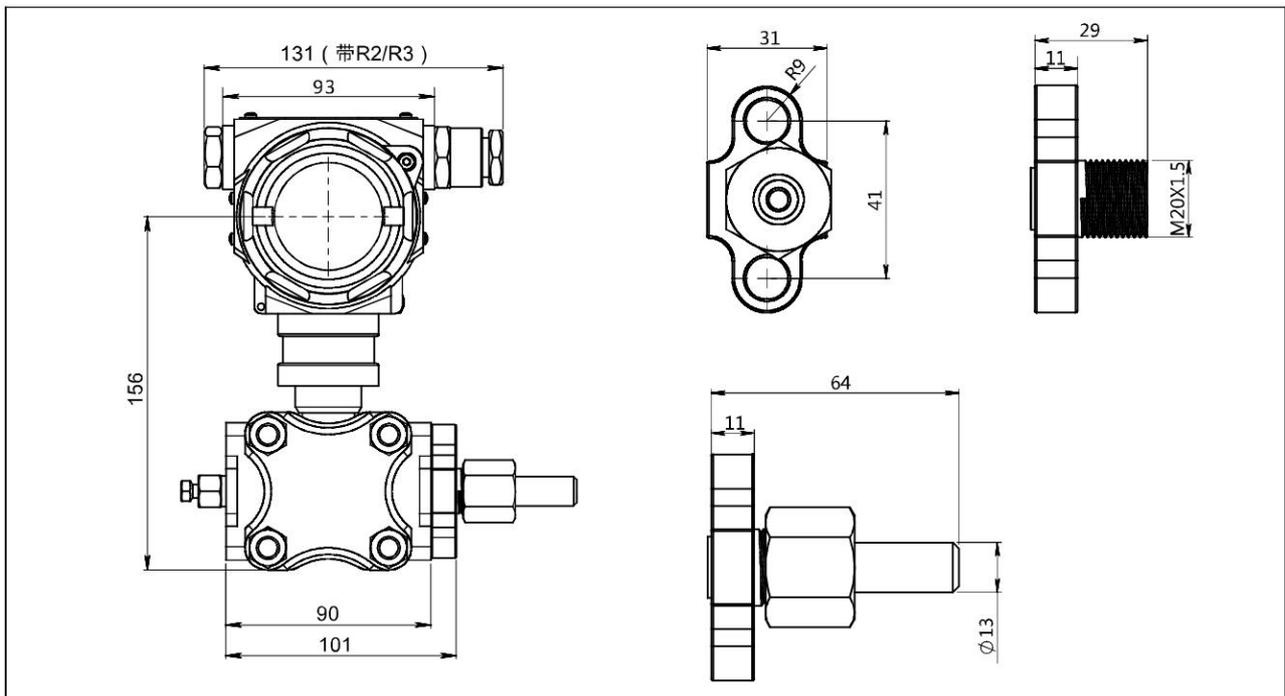
转接头 (A2) 组合尺寸图 (单位: mm)
